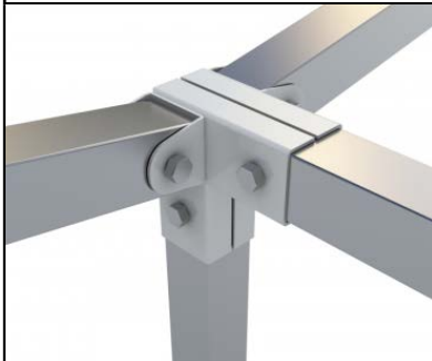
607 SMSLEE-04 Supporto 50x50 angolare piatto +oscillante bilaterale senza alette
